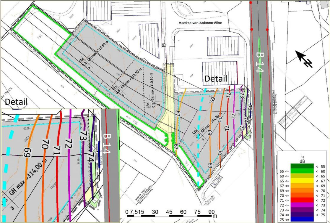
Abb. 3: Maßgebliche Außenlärmpegel nach DIN 4109
