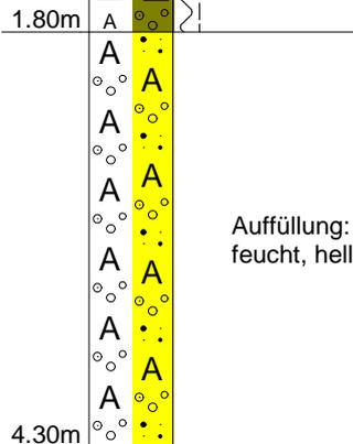
Auffüllung: Kies, schwach sandig, Ziegelbruch, Betonbruch, feucht, hellbraun, braungrau
